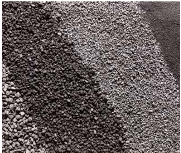
Aggregato artificiale Gripstone® nelle sue quattro pezzature
